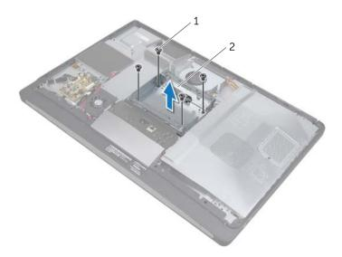
1 螺钉(4) 2 硬盘驱动器固定框架
